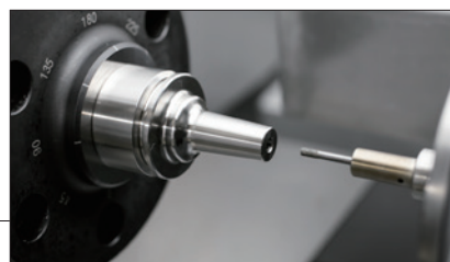
热装刀柄UNO精加工工序
